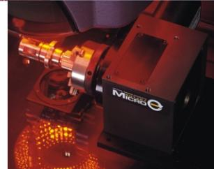
MeasureMind 3D steuert den OGP Micro-Theta™ Drehtisch. Die Referenzkoordinaten des Prüfteiles werden bei Rotation beibehalten und können mit jedem Sensor aufgenommen werden.
